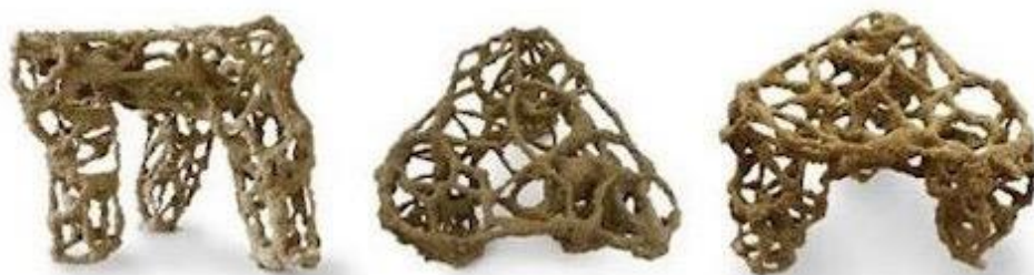
Рисунок 2: Рабочие образцы, полученные способом компонентной склейки
